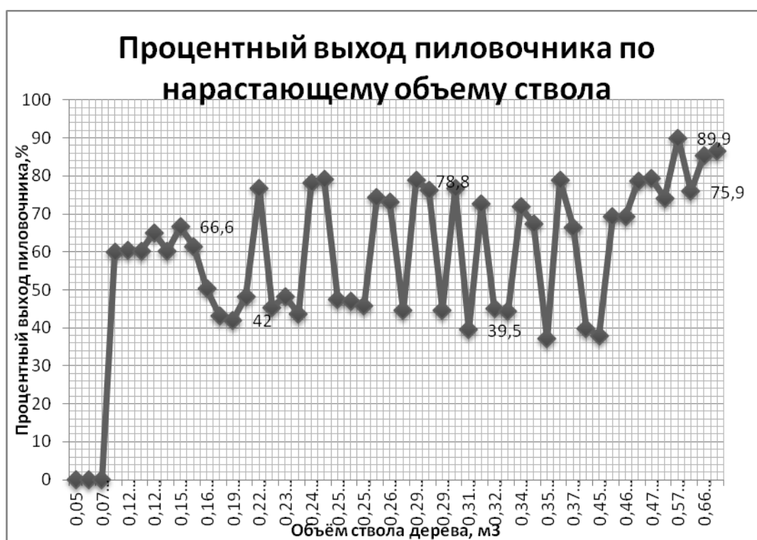
Рис. 4. Процентного выхода пиловочника по нарастающему объему ствола
