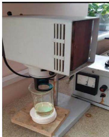
Рис. 2. Установка УФ-излучения фильтратов отбелки целлюлозы
