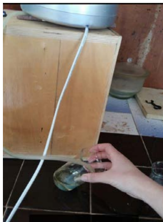
Рис. 1. Установка озонирования фильтратов отбелки целлюлозы
