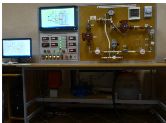
Рис. 2. Многофункциональный исследовательский лабораторный стенд «Автоматизированная котельная на жидком и газообразном топливе АК-01» с ПЭВМ удаленного доступа
